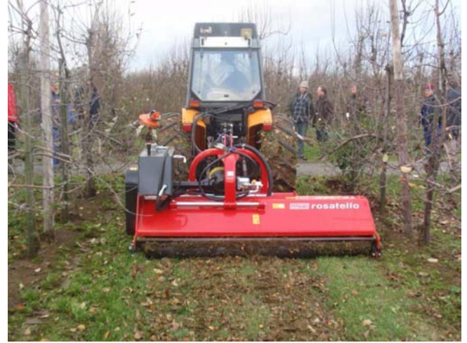
Ets Frejabise : Andaineur à balais à l'avant et broyeur Rosatello à l'arrière
