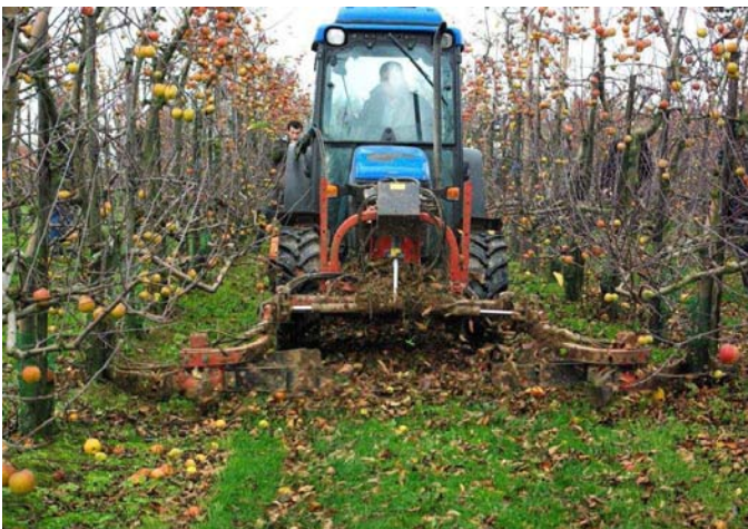
Ets Bamps : andaineur à pales à l'avant et broyeur BAB à l'arrière
