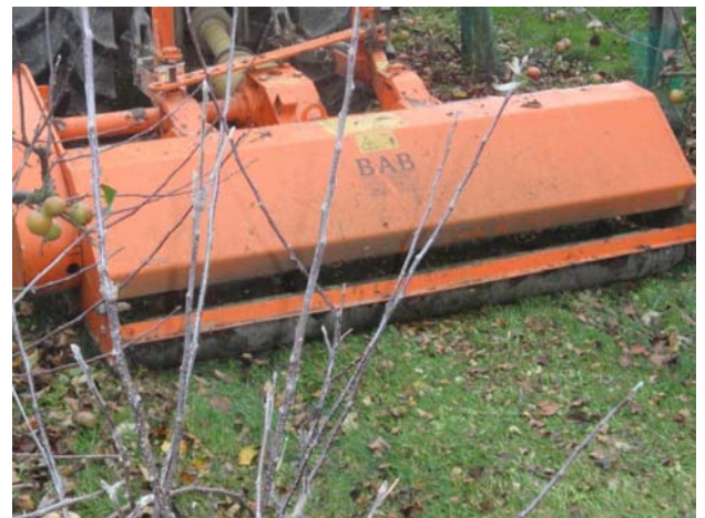
Ets Bamps : andaineur à pales à l'avant et broyeur BAB à l'arrière
