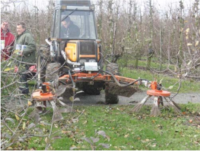
Ets Frejabise : Andaineur à balais à l'avant et broyeur Rosatello à l'arrière
