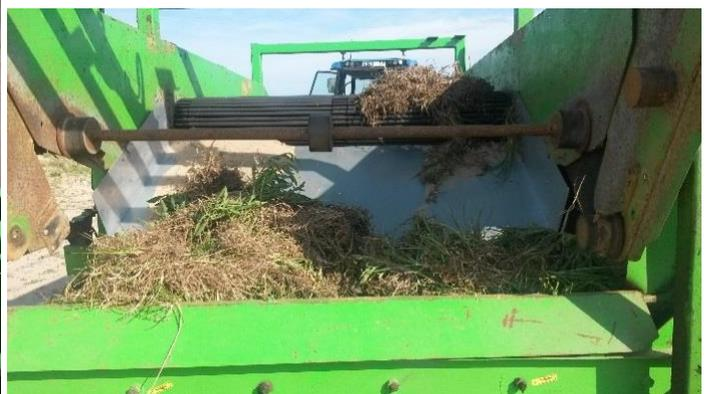
Figure 3 - Arrière de la machine : Biomasse souchet extraite avant transfert en remorque
