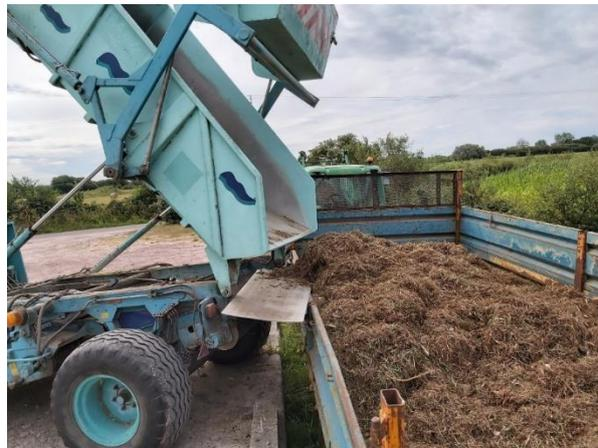
*Figure 6 - Machine tamiseuse cribleuse STR 3000*
