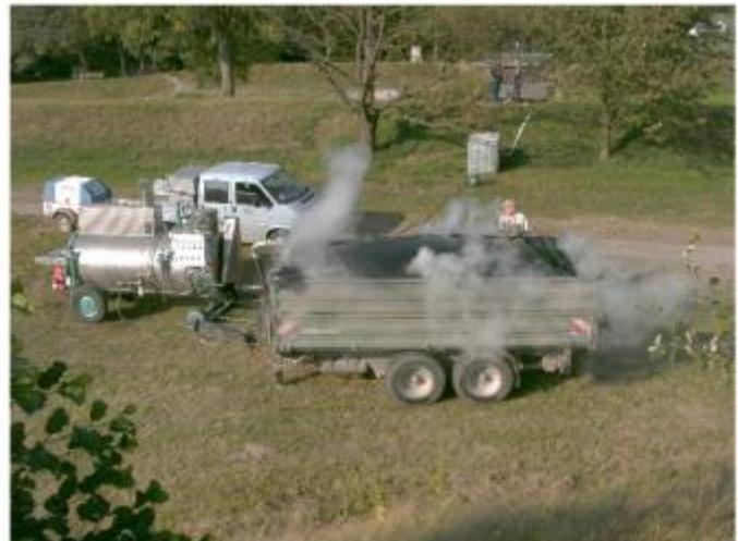
Figure 7 : Pour de grandes quantités de terre décapée, on peut équiper une remorque d'un dispositif injecteur de vapeur (photo : Möschle Seifert).
