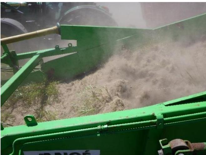
Figure 2 - 1er tapis de criblage de la machine
