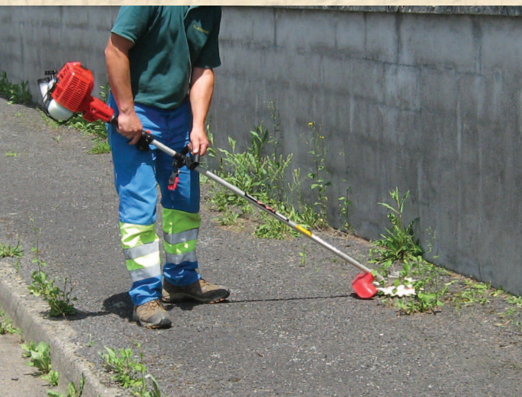
Débroussailleuse à lames réciproques le long d'un mur
