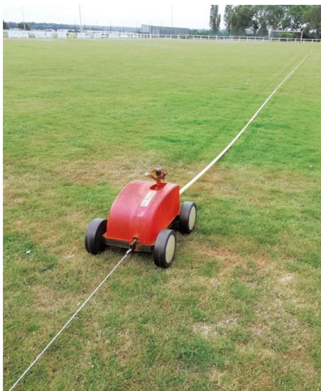
Roll-car utilisé pour l'arrosage d'un terrain de sport. / ©V. PAILLAT, FREDON Bretagne
