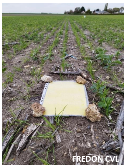
Figure 4 : Dispositif de plaque engluée
