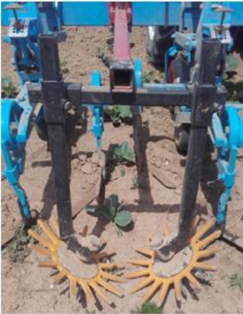
Binage des choux avec des doigts Kress (A. Claudel)
