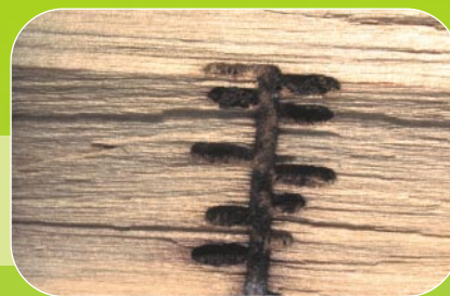
Dégâts de Xylébore disparate.
