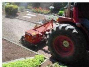
95. Image : Désherbeur de chemins mécanique WPD-LIPCO, LIPCO
