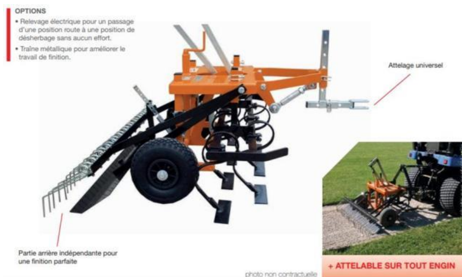
94. Image : Désherbeur mécanique BIN'TRAIL, YVMO
