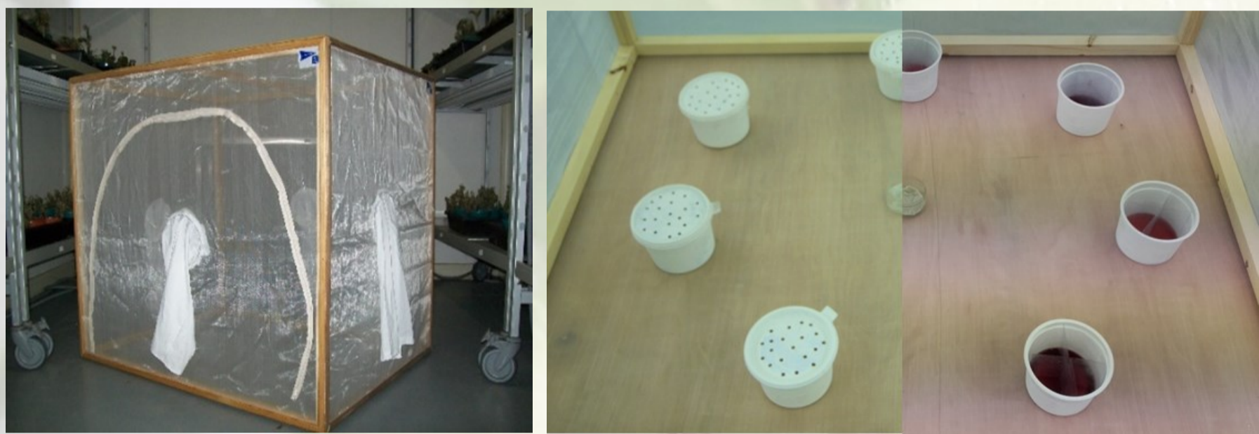
Olfactomètre utilisé pour définir en conditions contrôlées les appâts les plus attractifs
