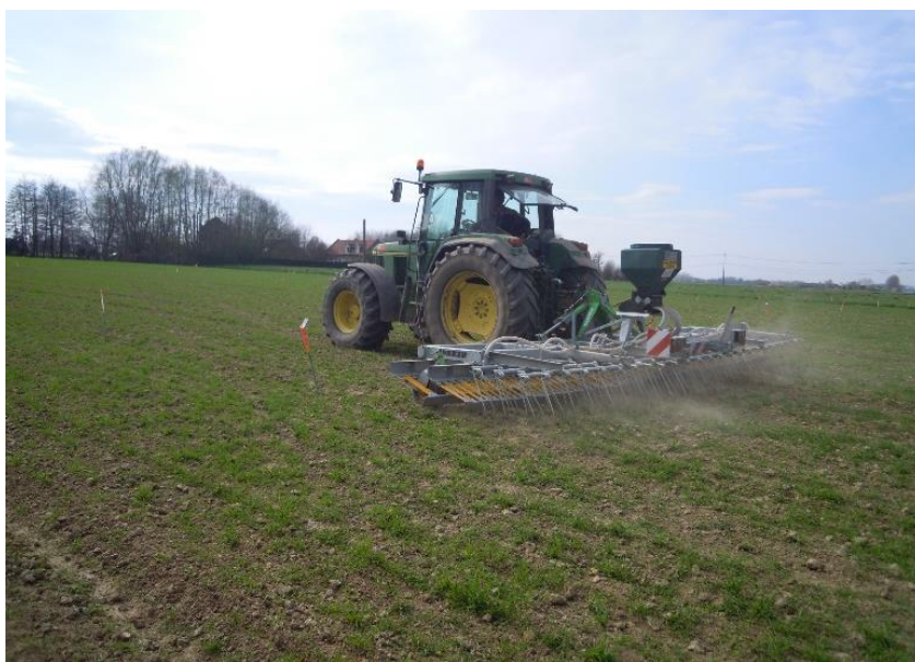
Passage d'une herse de prairie équipée d'un semoir pneumatique et d'une étrille
