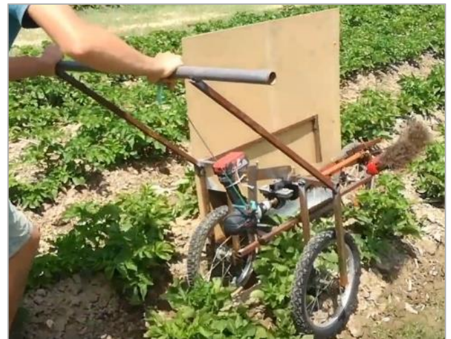
Figure 8 : Modèle de balayeuse auto-construite pour collecter les doryphores. Crédits photographiques : AgriBio 84, AgriBio 13, AgriBio 05.
