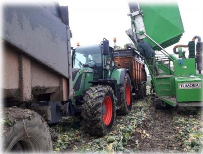
Fig. : la collecte séparée des tiges nécessite une adaptation de la trémie et de la logistique.
