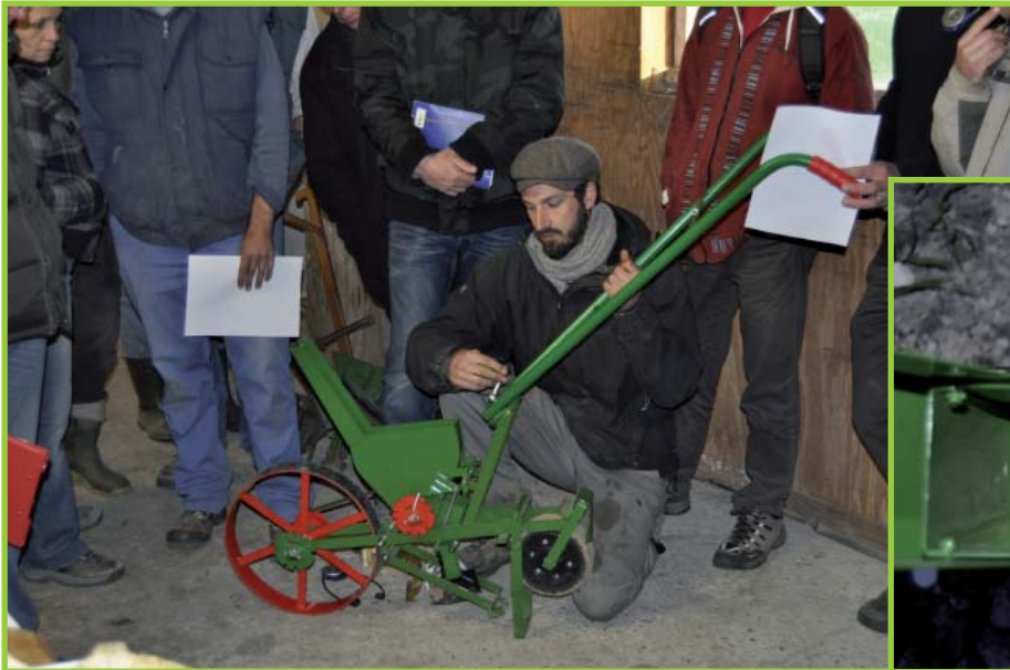
Le Miniair est un petit semoir manuel de précision. Les petites barres sur la roue dans la petite boîte en verre au milieu de la machine, sont appelés «nozzles»(tubes perforés). A la fin de chaque « nozzles », il y a un petit trou par lequel la graine est aspirée.
