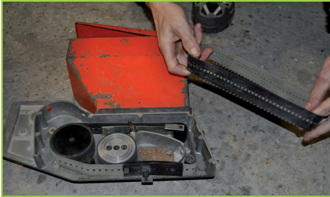
Le semoir manuel SEMBDER distribue les grains à l'aide de petites brosses et d'un étrier avec des ouvertures.
