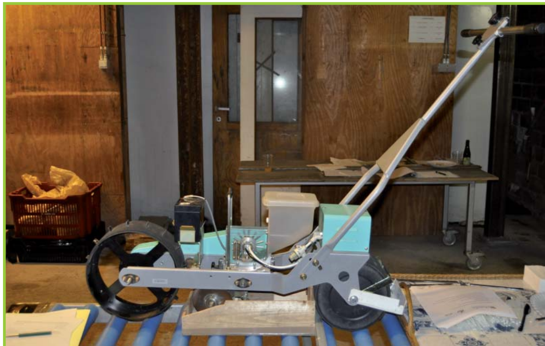
Le Miniair est un petit semoir manuel de précision. Les petites barres sur la roue dans la petite boîte en verre au milieu de la machine, sont appelés «nozzles»(tubes perforés). A la fin de chaque « nozzles », il y a un petit trou par lequel la graine est aspirée.
