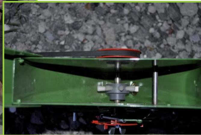
Le semoir manuel SEMBDER distribue les grains à l'aide de petites brosses et d'un étrier avec des ouvertures.
