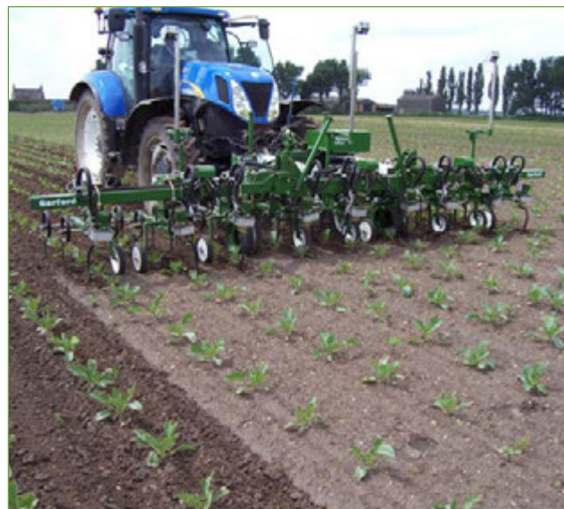
Figure 7 : Le robocrop, une technologie de reconnaissance des plantes permettant de biner sur la ligne
