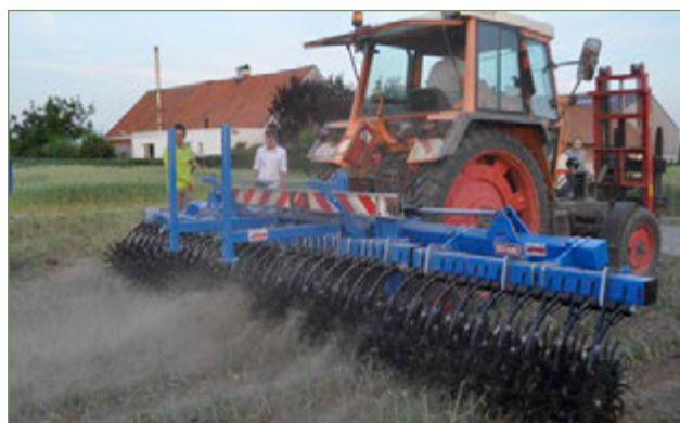
Figure 2 : Houe rotative désherbant en plein champ et à une vitesse élevée
