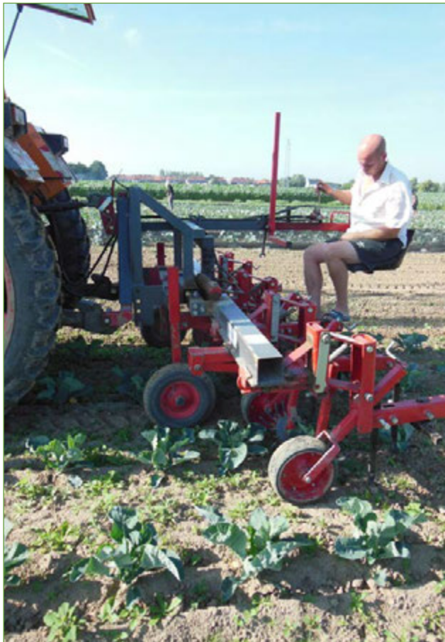
Figure 4 : Pour travailler avec davantage de précision, le châssis de la bineuse est réglé pendant le binage
