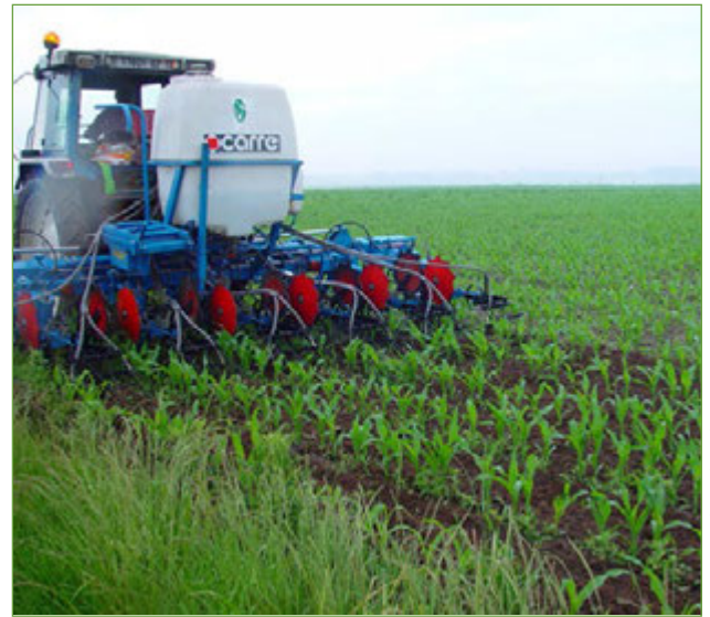
Figure 4 : Désherbineuse associant désherbage mécanique et chimique
