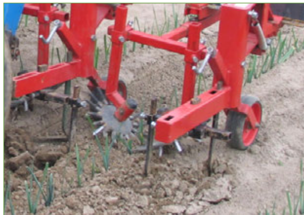
Figure 5 : Sarceuses à doigts suivies par des binettes, permettant de désherber aussi bien sur le rang qu'entre les rangs en un seul passage.
