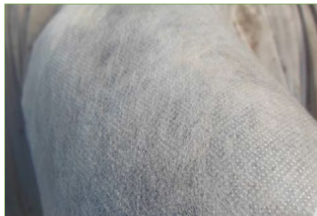
Figure 9 : Structure du voile non tissé
