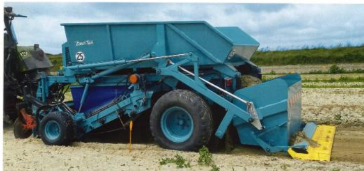
La tamiseuse à sable BeachTech STR 3000 de Kässbohrer, dont certains éléments ont été transformés pour répondre aux besoins identifiés dans les précédents projets.
