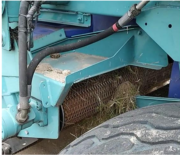
Figure 34. Zone de jonction entre le premier et le deuxième tapis de tamisage où des plantes retombent au sol
