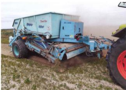
Figure 3 - Tamiseuse cribleuse pour exportation des organes de multiplication du couchet
