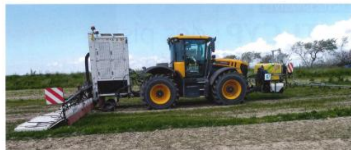
Machine de désherbage électrique MUCROP, expérimentée dans le cadre de la stratégie de jachère noire.
