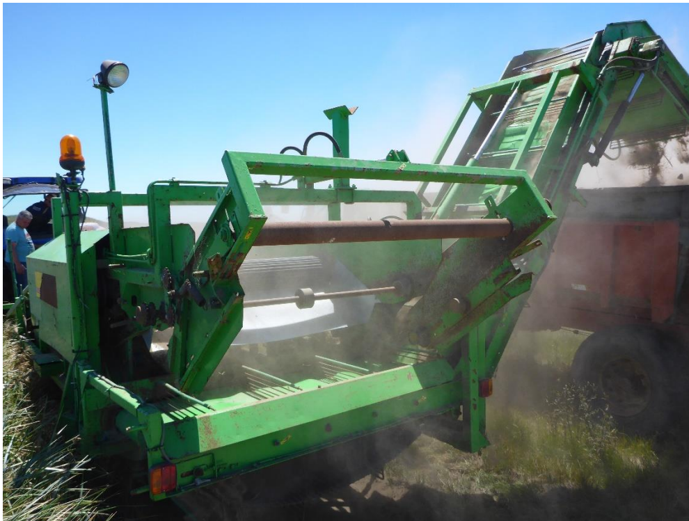
Figure 5 - Chantier d'extraction souchet par récolteuse-tamiseuse
